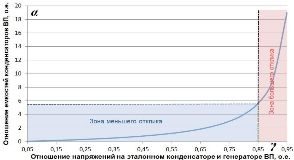
Рисунок 2.12 – Зависимость отношения емкости конденсаторов к отношению напряжений на эталонном конденсаторе и генераторе вторичного преобразователя
