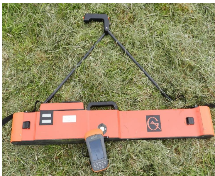
Рисунок 1.17 – Измеритель электропроводности EM38-МК2 измеряет как квадратурно-фазовую (проводимость), так и синфазную (восприимчивость) составляющие влажности почвы с помощью двух катушек индуктивности
