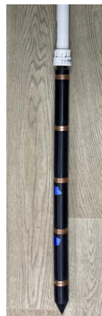
Рисунок 3.2 – Внешний вид первичного преобразователя и измерительной штанги
