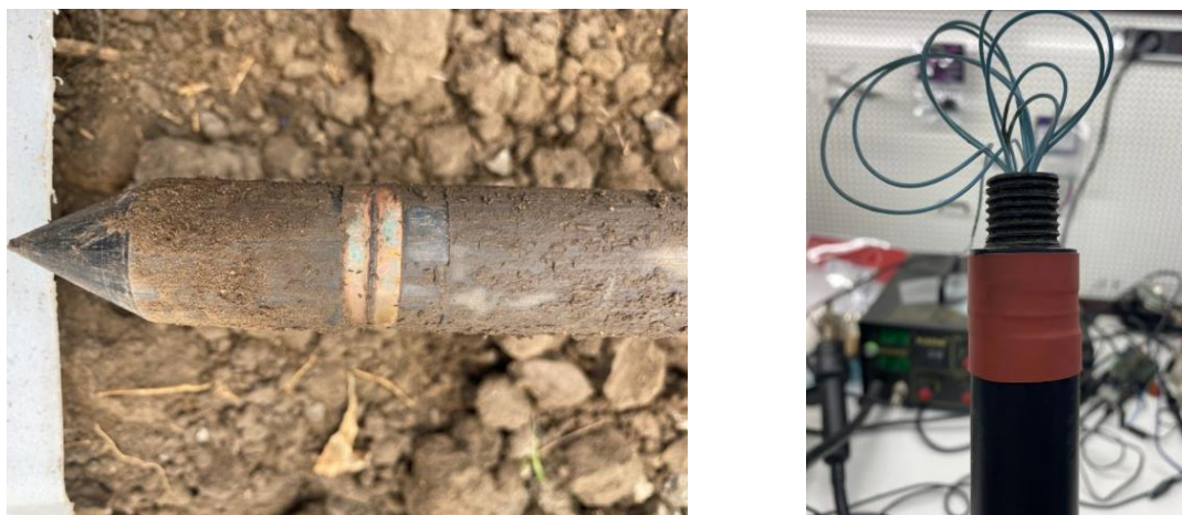
Рисунок 3.3 – Внешний вид измерительного конденсатора при прямом взаимодействии с почвой
