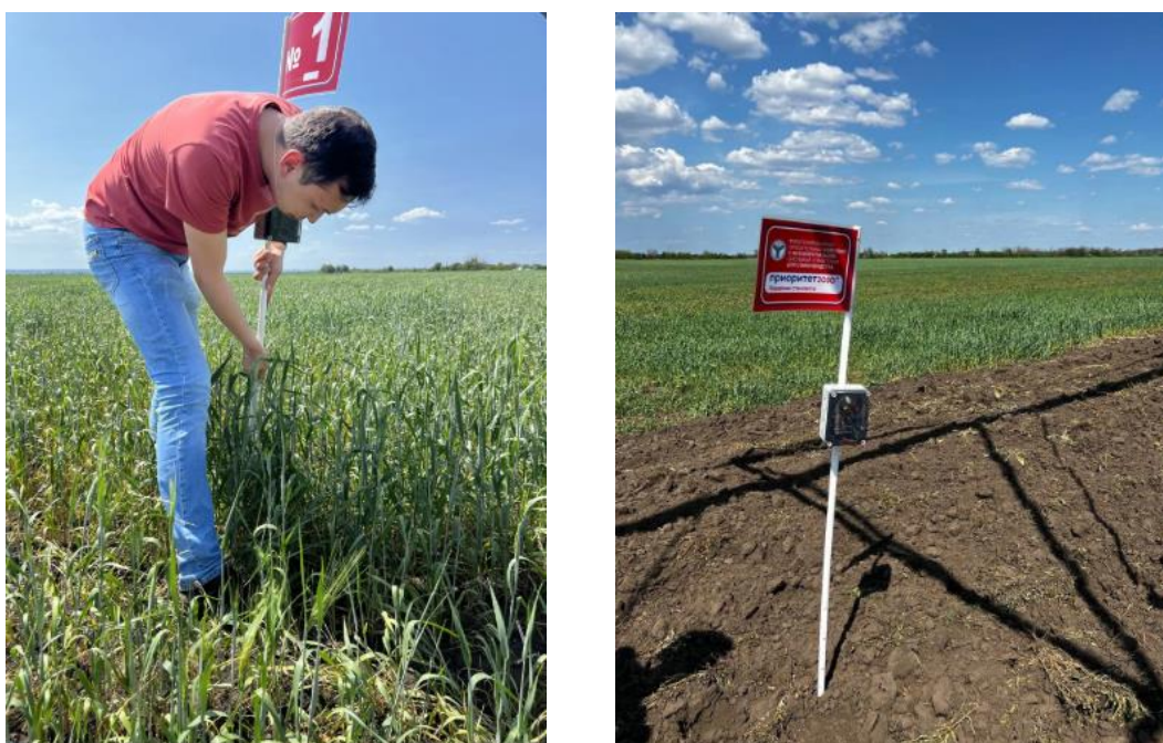
Рисунок 3.19 – Установка датчиков послойного контроля влажности на поле УНПО «Поволжье» (культура – пшеница)
